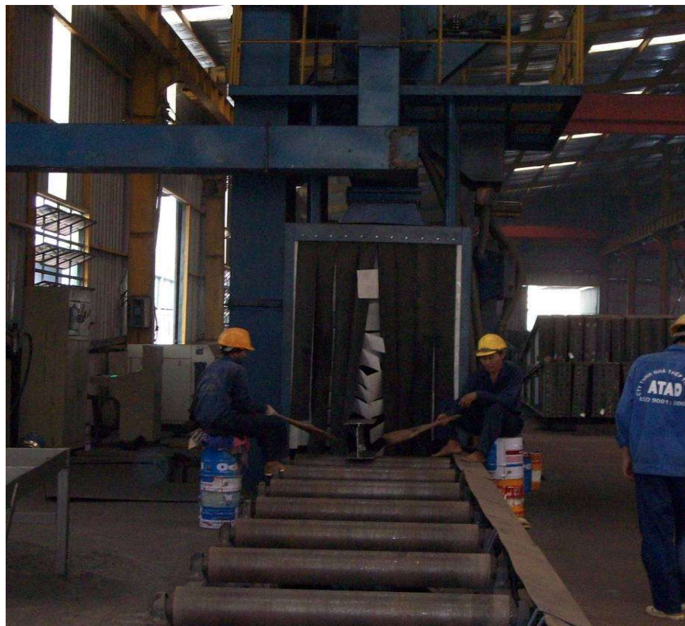
Làm sạch bề mặt bằng máy phun bi
