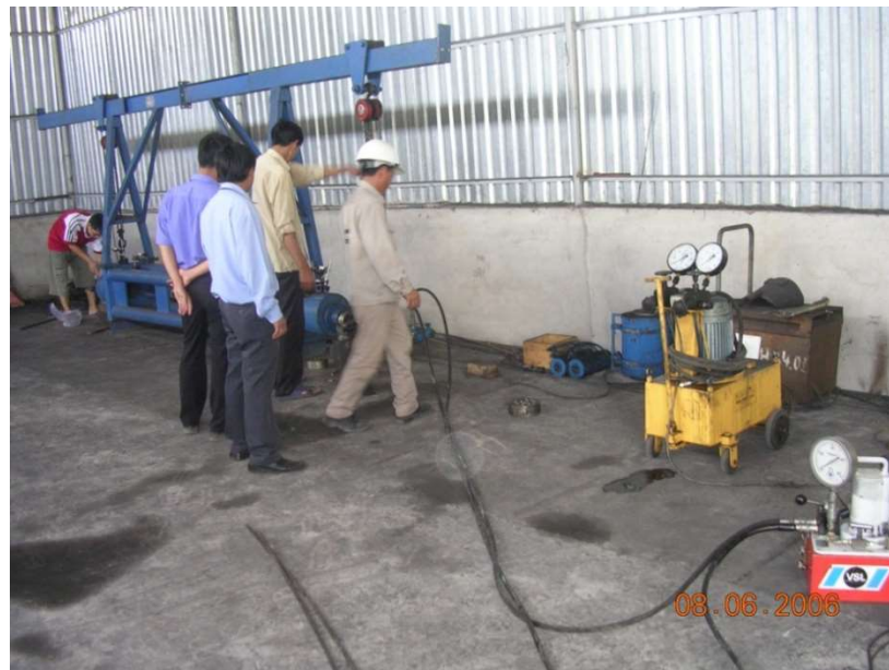
Thí nghiệm cường độ của cáp DUL, hệ neo
