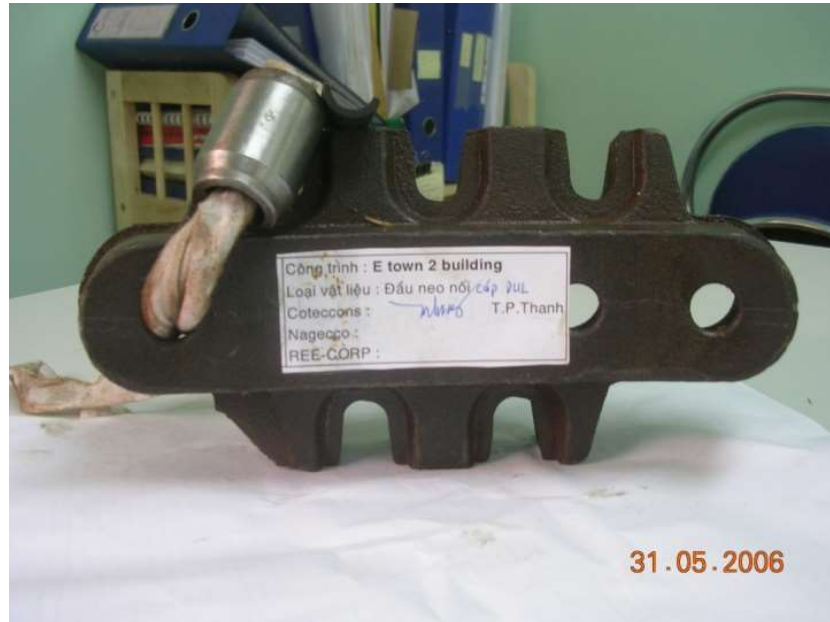
Mẫu đầu neo, nê m chuẩn bị đưa vào thí nghiệm
