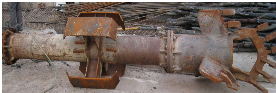
Mũi khoan đường kính 1m dùng để khoan tạo lỗ (phương pháp khoan tuần hoàn nghịch)
