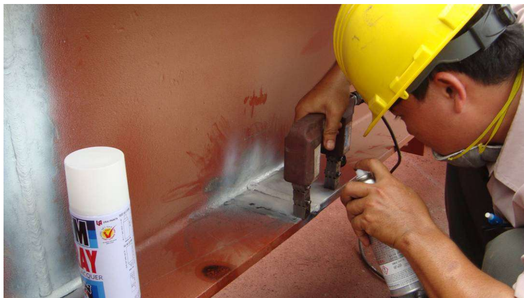
Kiểm tra đường hàn bằng phương pháp thử từ
