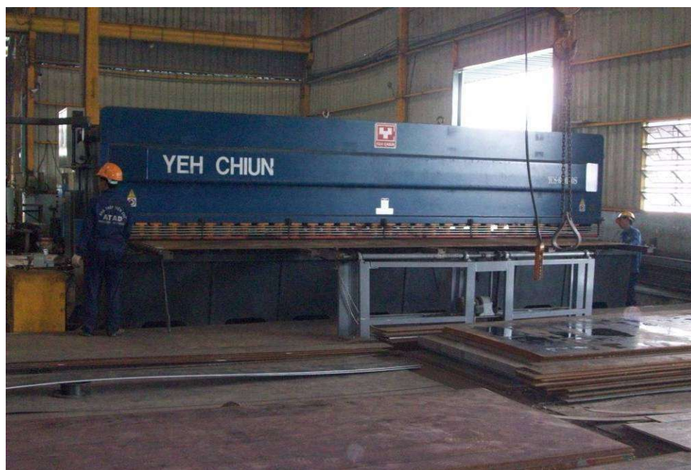
Cắt phôi thép tấm có chiều dày <18mm bằng máy
