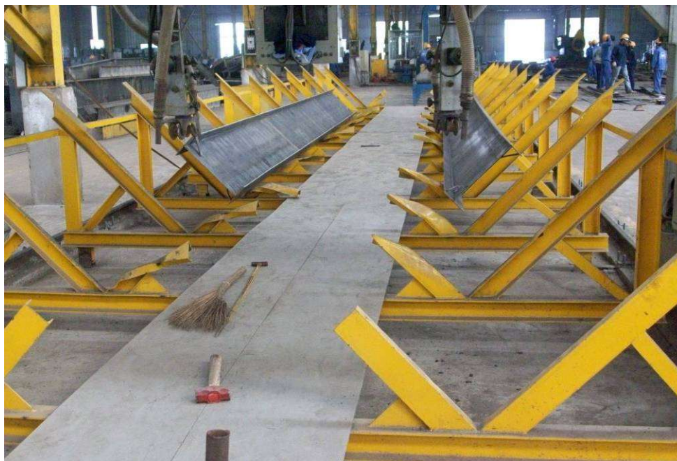
Hàn hoàn thiện bằng máy hàn tự động
